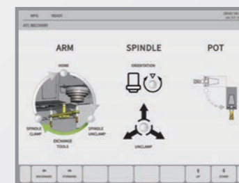
刀庫(ATC)重置設定 讓操作者依照圖形引導，重置自動換刀系統回原點。
