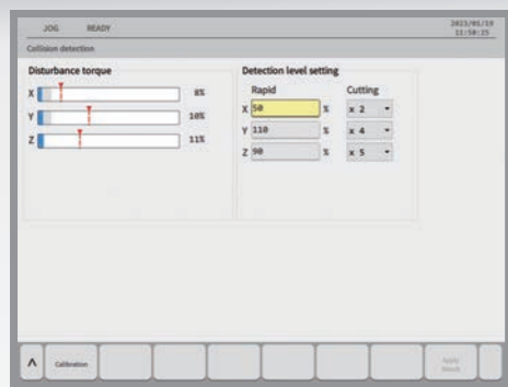
撞擊偵測保護 一旦偵測到撞擊，移動中的軸向進給即刻停止。
