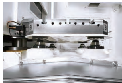
定位錐孔壓力偵測 確保定位精度在0.004 mm
