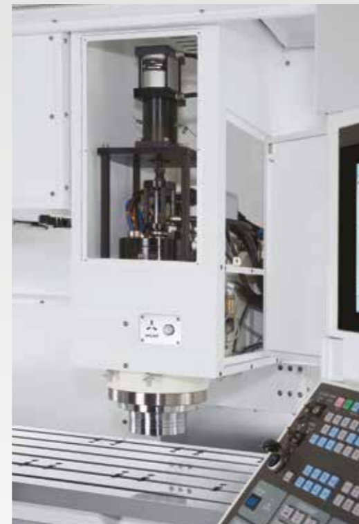
Een servicedeur om toegang tot de spil te bieden is standaard op alle modellen.
