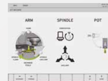
ATC HERSTEL ondersteuning bij het herstellen van de gereedschapswisselaar.
